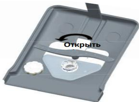
Шаг 1: Поверните фильтр против часовой стрелки.
